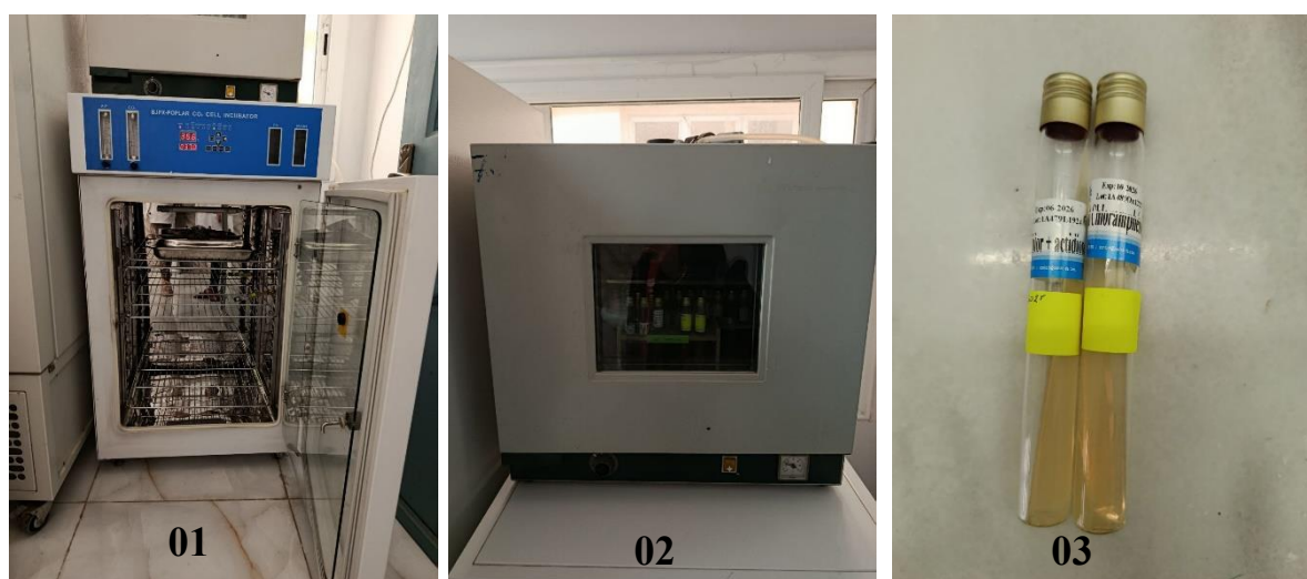
Figure 21 : Matériel de culture : (01) Etuve à 37 °C (02) Etuve à 27 °C (03) Les deux milieux de cultures (SC/SCA).
